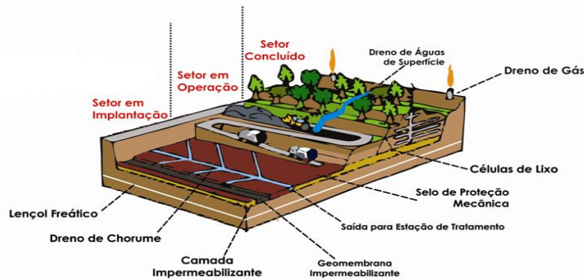
Figura 11: Figura esquemática de um aterro sanitário.
